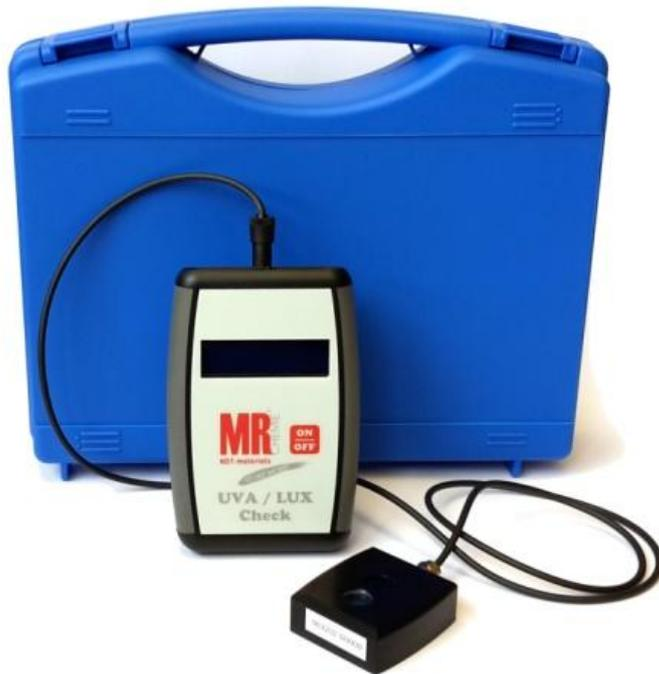
**MR<sup>®</sup> 454 UVA/Lux Check** ist ein Kombigerät für die Messung der UVA-Intensität und des Weißlichtanteils von UV-Leuchten bei der fluoreszierenden Rissprüfung.
