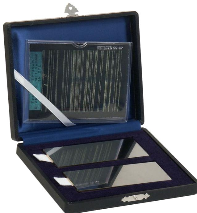
Der Kontrollkörper JIS Z 2343 besteht aus zwei rechteckigen Panels mit querliegenden Rissen sowie einer NiCr-Beschichtung. Die dicke der Beschichtung und somit auch die Risstiefe variieren je nach Anwendung von 10 bis 50 µm.
