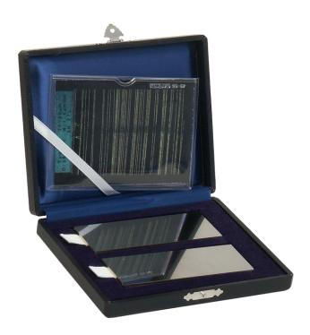
Der Kontrollkörper 1, gemäß DIN EN ISO 3452-3, dient zur Kontrolle der Anzeigefähigkeit und Definition der Empfindlichkeit von Eindringprüfmitteln.
