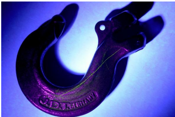
Anzeige des Prüfmittelsystems auf einem Lasthaken und einer Schweißnaht, geprüft nach DIN EN ISO 9934-1
